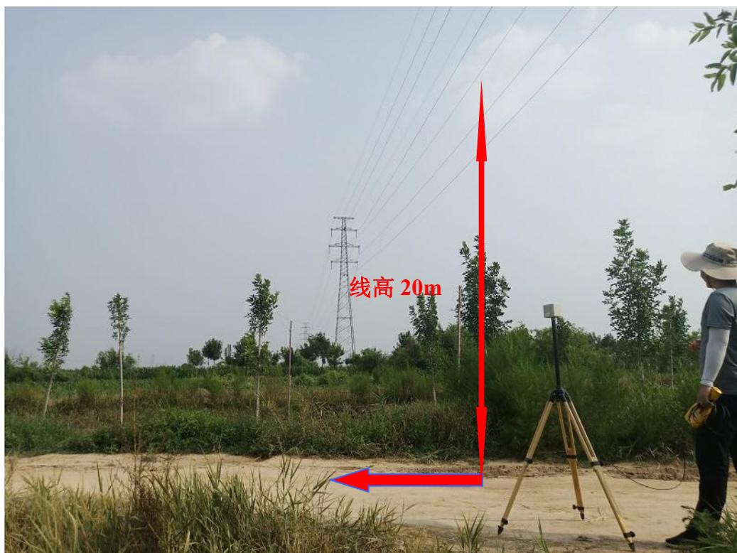
图 7-5 双回架设 110kV 杨李线 5#-6#之间，向东衰减
